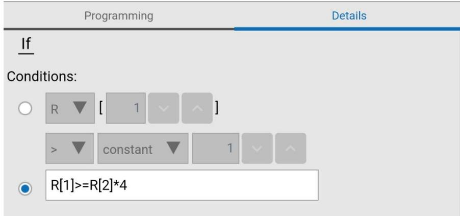
Fig. 4.3.7(d) Text Input to Define Condition
